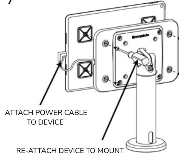
ATTACH POWER CABLE TO DEVICE
